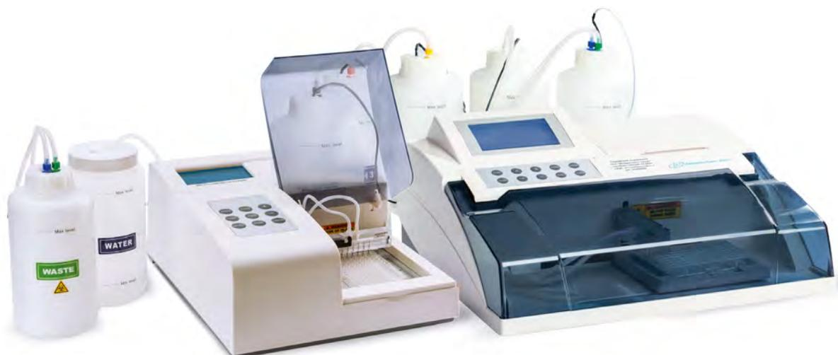
**ImmunoChem 2600** – компактный автоматический промыватель микропланшет (вошер) в двух вариантах.
